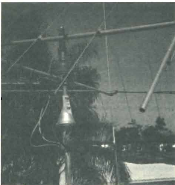
Fig. 2 - La realizzazione di W4BE con due Rotatori CDE. Quello del movimento azimutale è un CD 45. Quello sopra, per l'angolazione verticale è il più piccolo modello per antenne TV.
