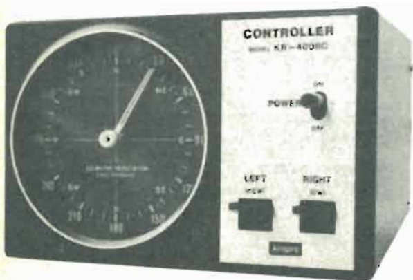
Fig. 3 : La cassetta di comando con grande scala illuminata e lancetta che copre 360° del quadrante per rotatori KR 400 e 600 - variante RC prodotti per la UKW-Technik (rappr. esclusivo Armenghi-Bologna). Dimensioni della cassetta 19 x 14 x 15 cm; diametro scala 105 mm.
